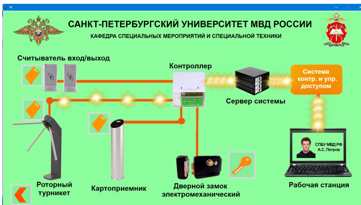
Рисунок 1. Вид рабочего окна программы при демонстрации системы контроля и управления доступом в служебное помещение органов внутренних дел Российской Федерации
